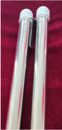
图 6. 旗桅组件由一根管子组成，旗帜的升降机附在一根管子上，而旗杆又夹在另一根管子上，旗帜升降索穿过该管子。
