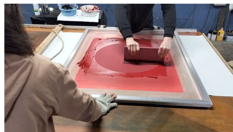
图 4c. 放置织物；图 4d：在织物正面涂抹颜料进行染色。（图片取自作者在制造工厂拍摄的视频）
