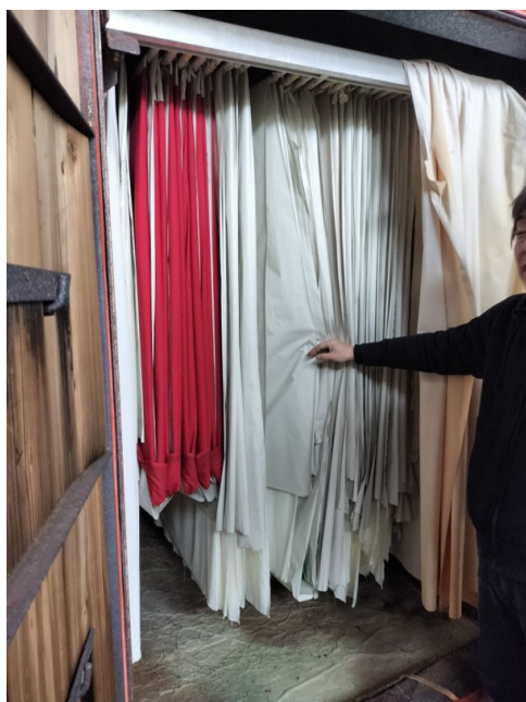
图6. 悬挂在蒸汽设备中的织物。温度和时长可以控制。（照片由作者拍摄）
