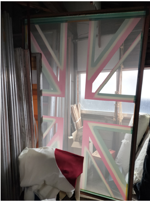
图 3a. 英国国旗的模版。由于红色和蓝色区域用白色镶边（分隔颜色），所以一个模版就可以用于印染这两种颜色。 Figure 3a. Stencil for U.K. flag. Since the red and blue areas are fimbriated in white (separating the colors), one stencil works for dyeing both colors.
